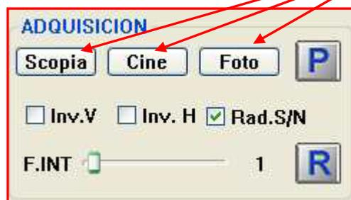
**MODO SCOPIA:** En este modo, cuando se presiona el pedal de **radioscopia** se ve la imagen en directo en el monitor 1. La imagen queda congelada al soltar el pedal.
