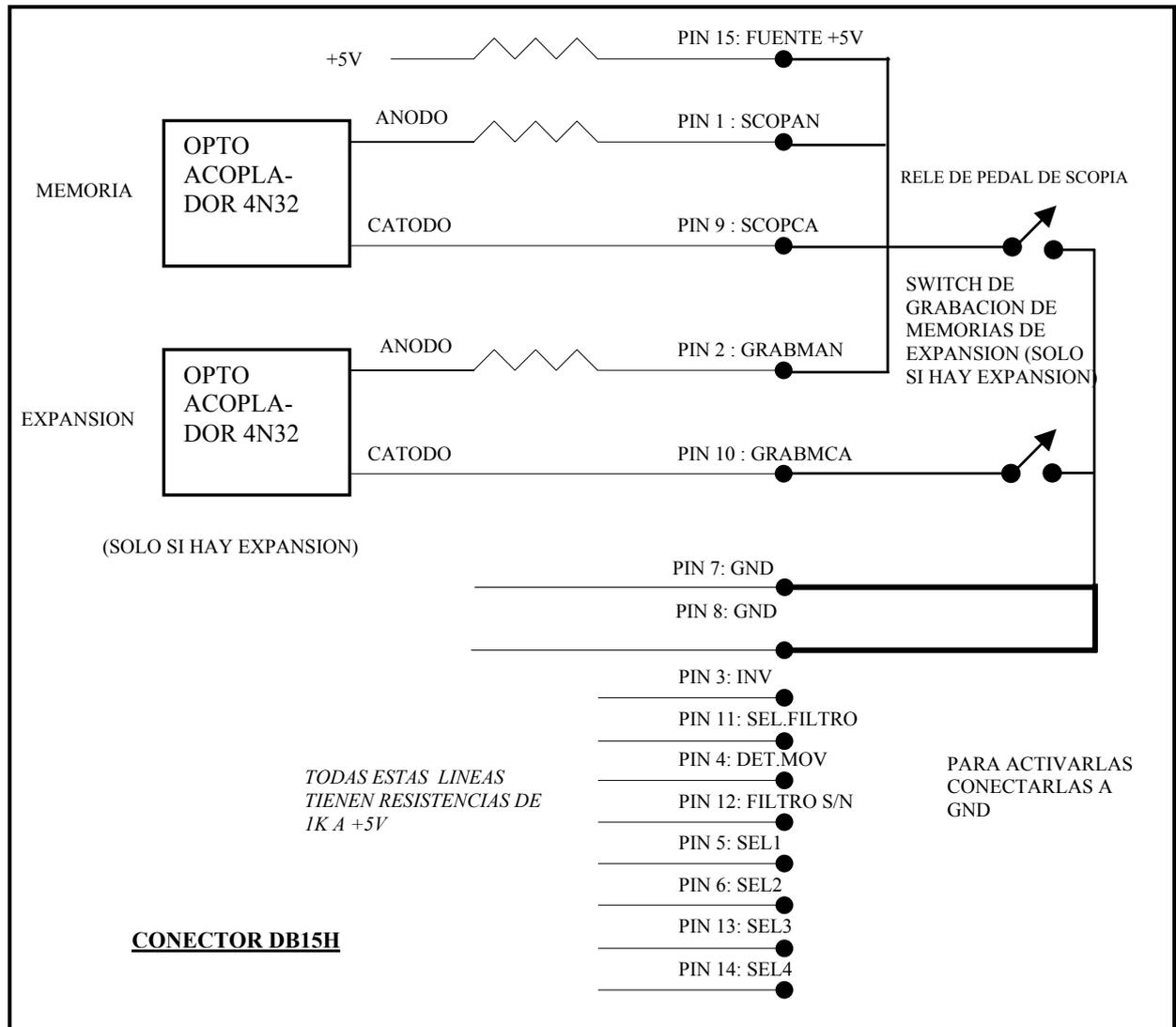
Para lograr el efecto de “última imagen congelada” deben conectarse los Pines 15(GND) y 1 (SCOPAN) a un relé normal abierto que se cierre cuando se presiona el pedal de radioscopía independientes del resto del circuito y libres de toda tensión externa. Estos contactos se cerrarán cuando se presione el pedal activando la adquisición digital, y se abrirán cuando se deje de presionar el pedal, congelando la última imagen. Puede ser necesario incluir
